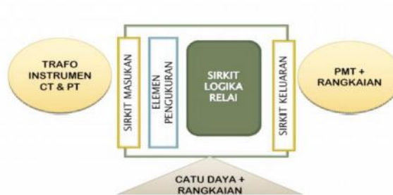
Gambar 2.1 Komponen Utama Relai Proteksi
