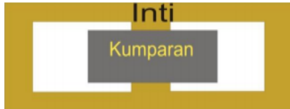
Gambar 2.11 Kontruksi Core Type (Jenis Inti)
