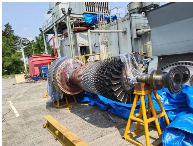
Gambar 2.4 Turbin di PLTGU
