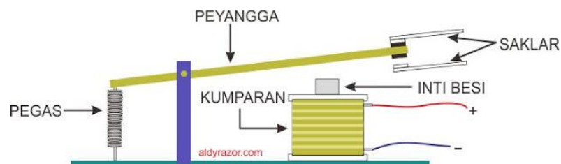
Gambar 2.11 Skematik Modul Relay
