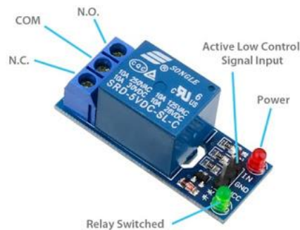
Gambar 2.9 Skema Modul Relay Arduino
