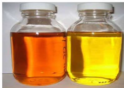
Gambar 2.21 Minyak Isolasi Transformator
