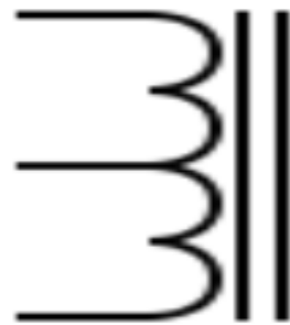
Gambar 2.6 Skema Auto Transformator
