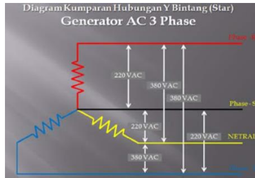
Gambar 2.14 Rangkaian Ekuivalen Generator 3 Fasa
