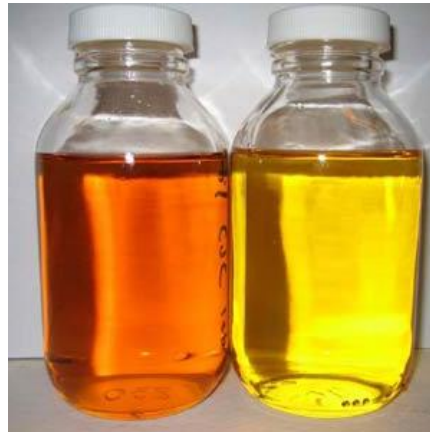
Gambar 2. 8 Minyak isolasi transformator
