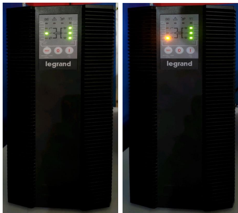
Gambar 2.20. A. Kondisi saat bypass melalui UPS, B. Kondisi saat menggunakan baterai
