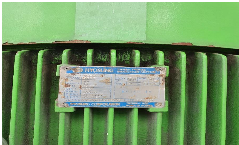
Gambar 2.3. Foto nameplate pada sebuah motor induksi
