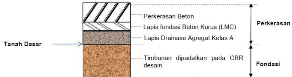
Gambar 2.26 Gambar tipikal perkerasan kaku pada permukaan tanah asli
