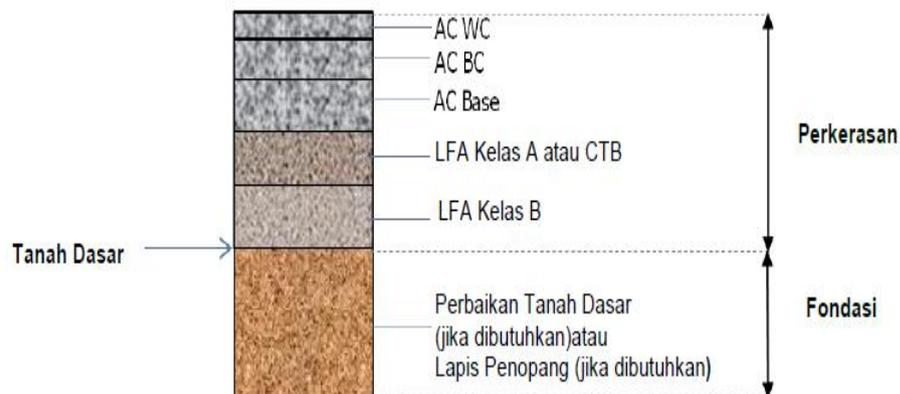
**Gambar 2.26** Perkerasan Lentur Pada Permukaan Tanah Asli
