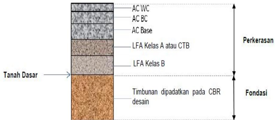
**Gambar 2.27** Perkerasan Lentur pada timbunan
