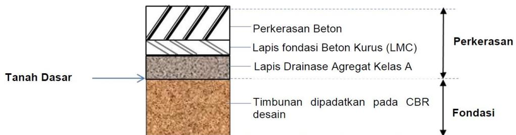
Gambar 2.26 Gambar tipikal perkerasan kaku pada timbunan
