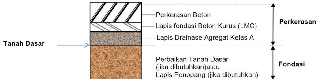
Gambar 2.25 Gambar tipikal perkerasan kaku pada permukaan tanah asli
