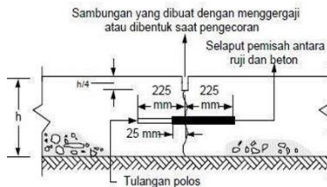
Gambar 2.24 Sambungan Susut Melintang dengan Ruji
