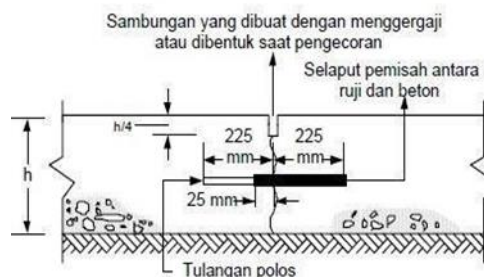
Gambar 2.18 Sambungan susut melintang dengan ruji
