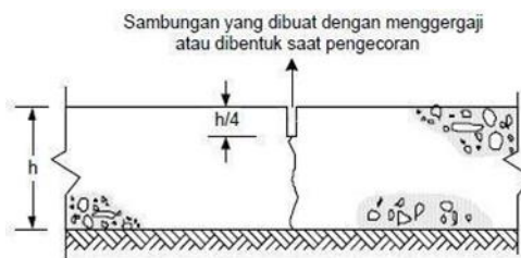
Gambar 2.17 Sambungan susut melintang tanpa ruji
