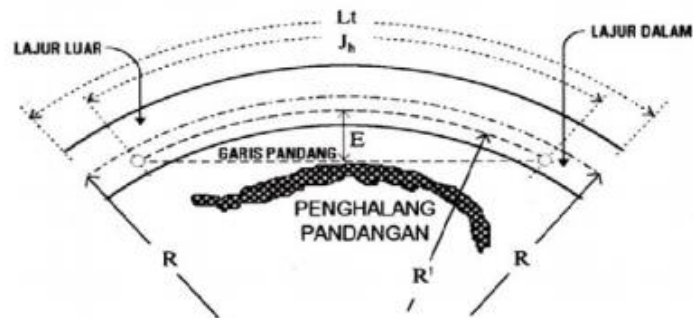
Gambar 2.24 Daerah bebas samping ditikungan untuk J_h < L_t
