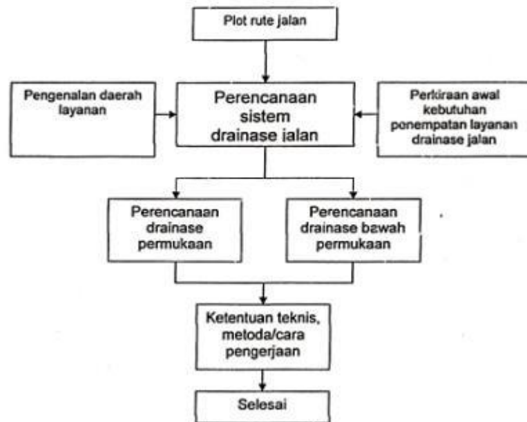
Gambar 2.48 Skema Perencanaan Sistem Drainase Jalan (Perencanaan Sistem Drainase Jalan Departemen Pekerjaan Umum, 2006)
