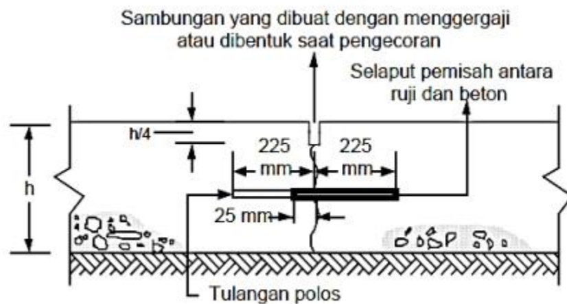
Gambar 2.40 Sambungan Susut Melintang dengan Ruji
