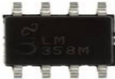
**Gambar 2.13 :** Bentuk Fisik IC LM358
