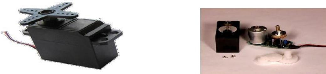
**Gambar 2.5 :** Bentuk Motor Servo (Kiri), Komponen Internal Motor Servo (kanan)
