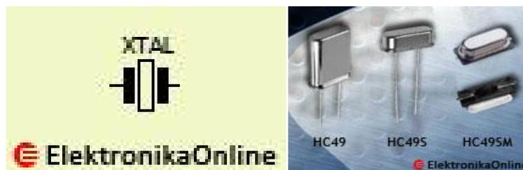
**Gambar 2.20** : Simbol Kristal (Kiri), Bentuk fisik Kristal (Kanan)
