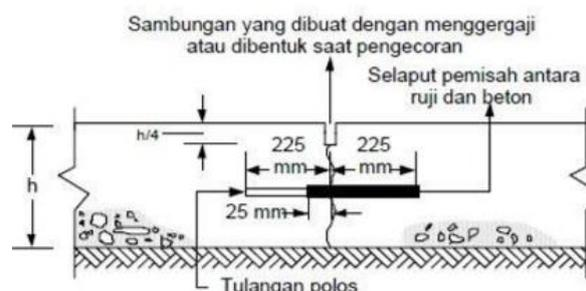
Gambar 2.20 Sambungan Susut Melintang dengan Ruji
