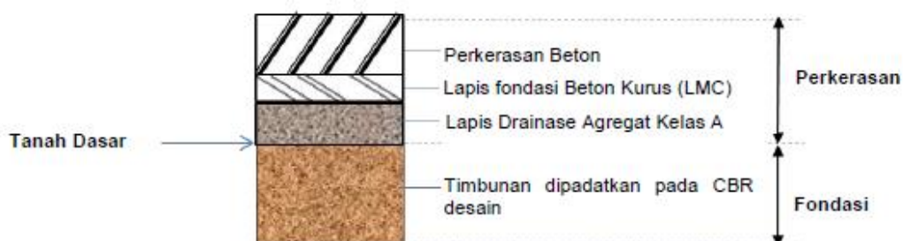
Gambar 2.20 Tipikal perkerasan kaku pada timbunan
