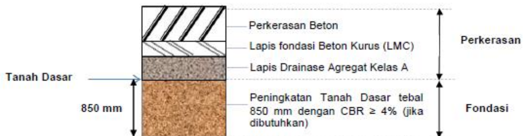
Gambar 2.21 Tipikal perkerasan kaku pada galian
