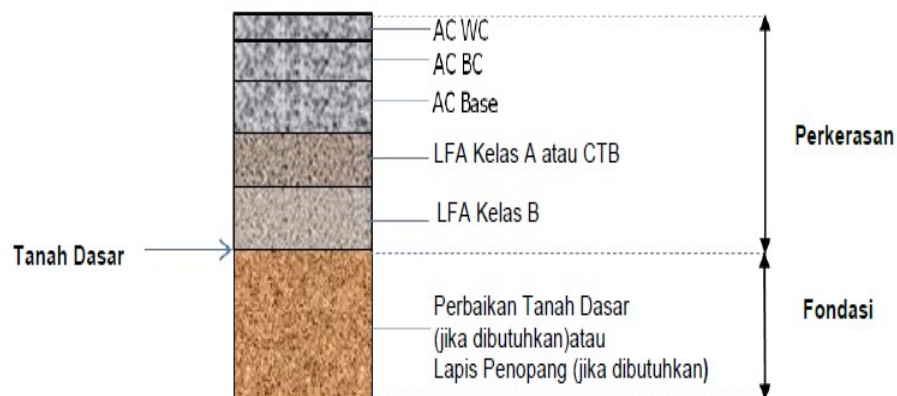
Gambar 2.26 Perkerasan Lentur Pada Permukaan Tanah Asli
