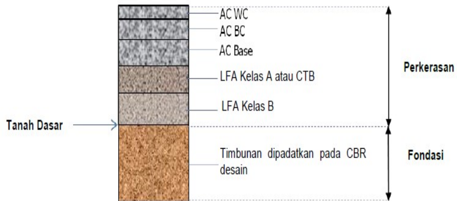
Gambar 2.27 Perkerasan Lentur pada timbunan
