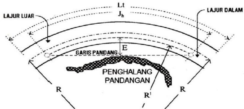
Gambar 2.18 Daerah Bebas Samping Di Tikungan, Untuk  $J_h < L_t$
