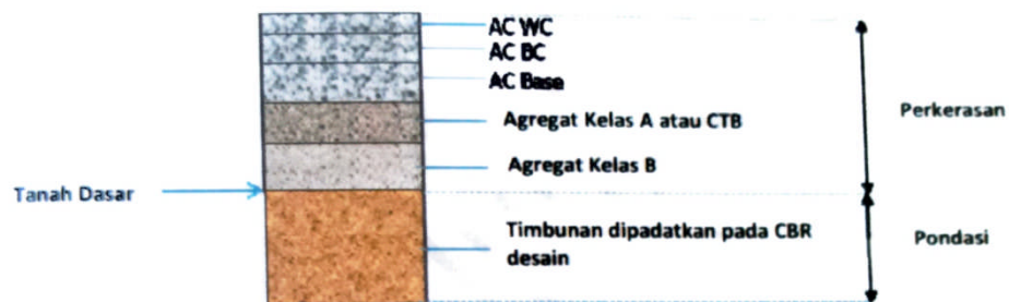
Gambar 2.28 Lapisan Perkerasan Lentur Pada Timbunan
