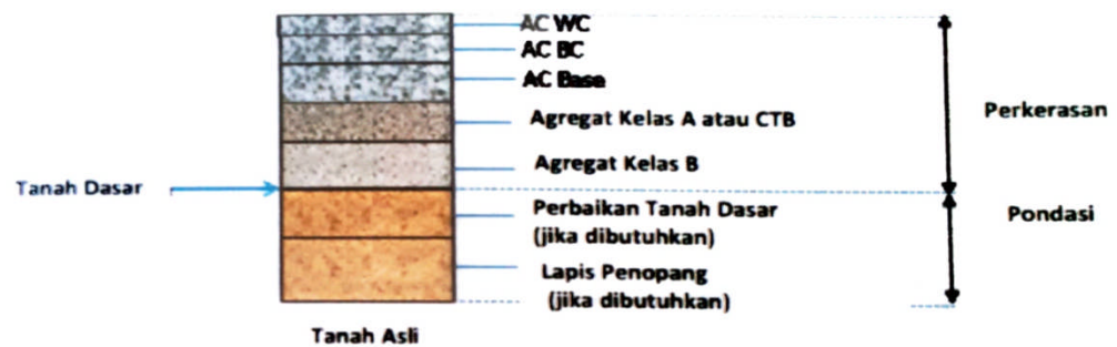
Gambar 2.27 Lapisan Perkerasan Lentur Pada Permukaan Tanah Asli
