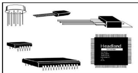
**Gambar 2.24** Beberapa Bentuk *Integrated Circuit* (IC)
