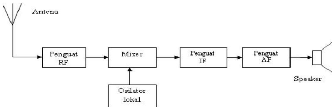
**Gambar 2.1 Diagram Blok Rangkaian Penerima Radio AM**
