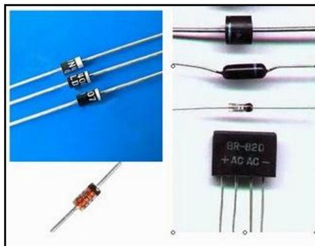
**Gambar 2.26** Bentuk Fisik Dioda
