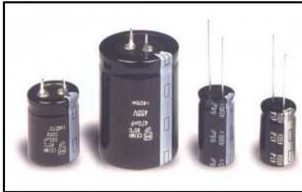
Gambar 2.22 Kapasitor Elektrolit (Sumber: Elektronika Dasar. 2012. Jenis-jenis Kapasitor elektronika-dasar.web.id/teori-elektroika/jenis-jenis-kapasitor/ )
