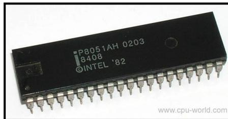
**Gambar 2.13 IC Mikrokontroler 8051**
