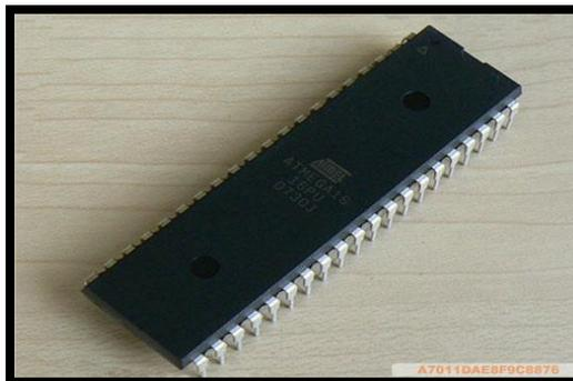
**Gambar 2.16 Mikrokontroler ATmega 16**
