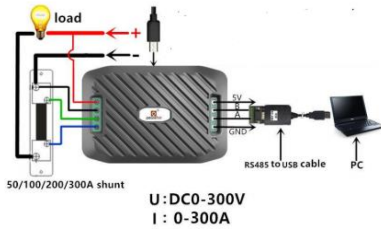
Gambar 37. Skema rangkaian PZEM 017
