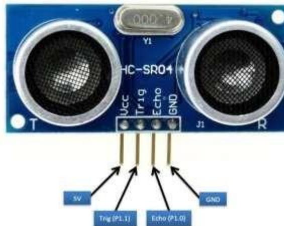
**Gambar 2. 3 Konfigurasi pin dan tampilan sensor ultrasonic HC-SR04**
