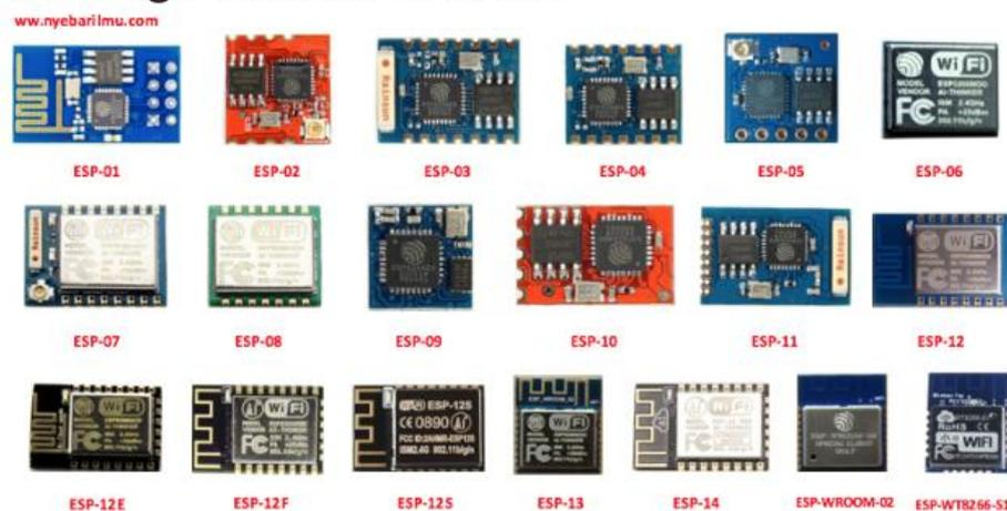
**Gambar 2.14** Keluarga Module ESP8266 <sup>[8.]</sup>
