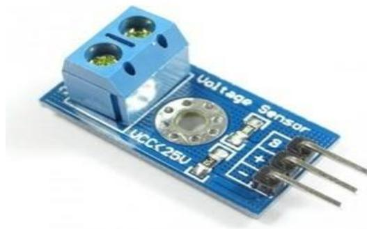
**Gambar 2.13 Sensor Tegangan**
