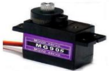
Gambar 2.2 Motor Servo Pengangkat Palang
