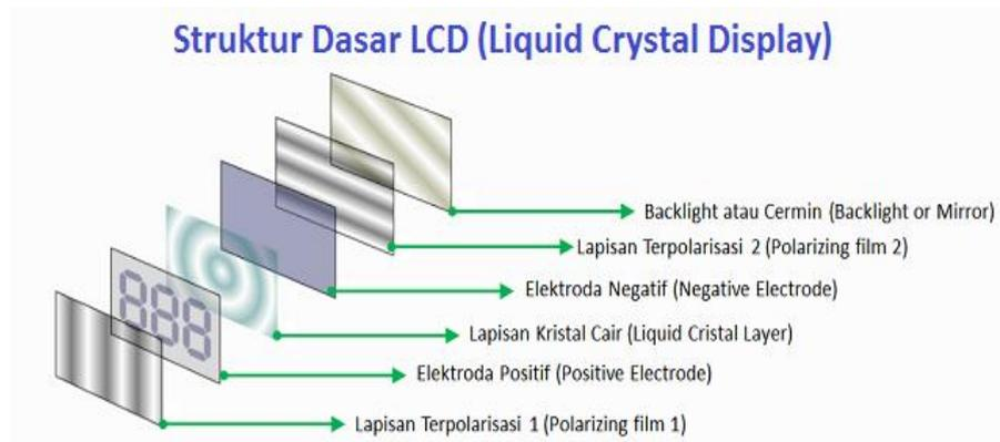
**Gambar 2.5** Struktur LCD<sup>[13]</sup>
