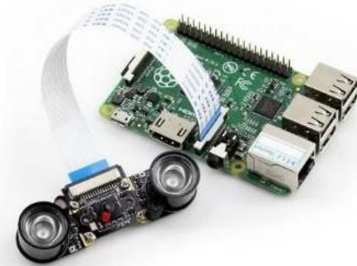
Gambar 2.5. Antarmuka Raspberry Pi *Camera Module* dengan Raspberry Pi 3
