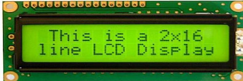
**Gambar 2.4** LCD 16 x 2<sup>[10]</sup>
