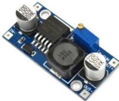
Gambar 2.8 Modul Step Down LM2596<sup>[15]</sup>
