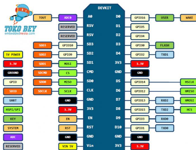
Gambar 2.5 Skematik Posisi Pin NodeMCU Devkit V2
