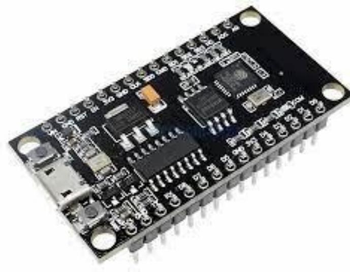
**Gambar 2.7** NodeMCU8266
