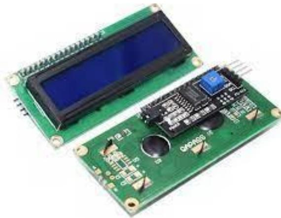
**Gambar 2.9** LCD 16x2 digabung dengan I2C
