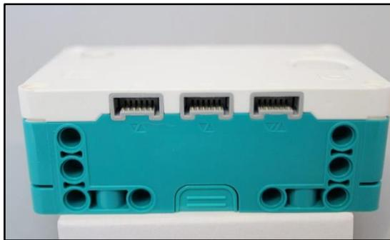
**Gambar 2.13** *Input dan Output 51515 Brick*
