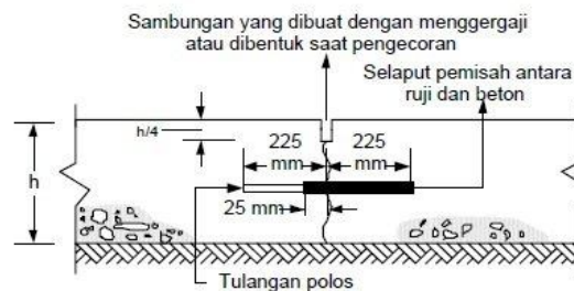
Gambar 2.29 Sambungan Susut Melintang dengan Ruji
