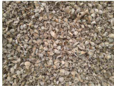
Gambar 2.4 Cangkang sawit yang dipakai sebagai penganti agregat kasar
