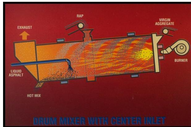
Gambar 2.6 Proses Pengolahan RAP pada Drum Plant
