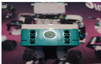
Gambar 2. 21 Bagian Bawah Lego Large Hub 51515
