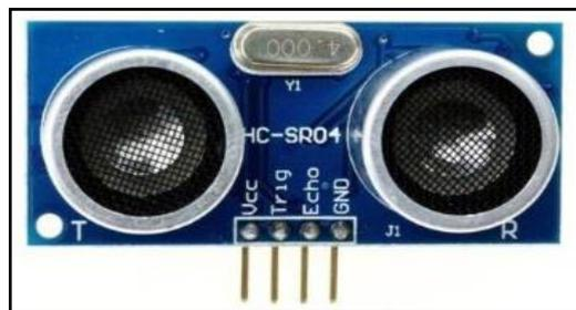
**Gambar 2.5.1** Sensor Ultrasonik
