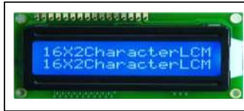
Gambar 2.17 Bentuk Fisik LCD 16 x 2
