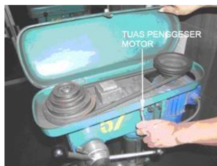
Gambar 2.16. menarik tuas penggeser pulimotor (Sutopo, 2004)
