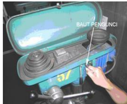
Gambar 2.15. Mengendorkan pengunci puli motor (Sutopo, 2004)
