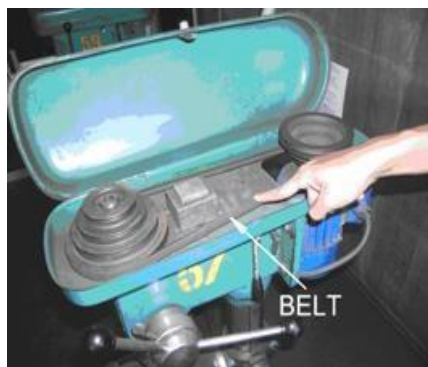
Gambar 2.10. Pengecekan kekencangan belt
