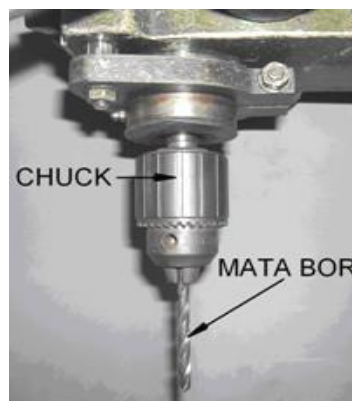
Gambar 2.20. Mata bor yang sudah terpasang pada chuck (Sutopo, 2004)
