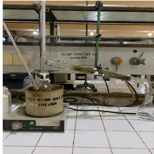
Gambar C.6 Proses pemisahan ekstrak dengan pelarut dengan distilasi
