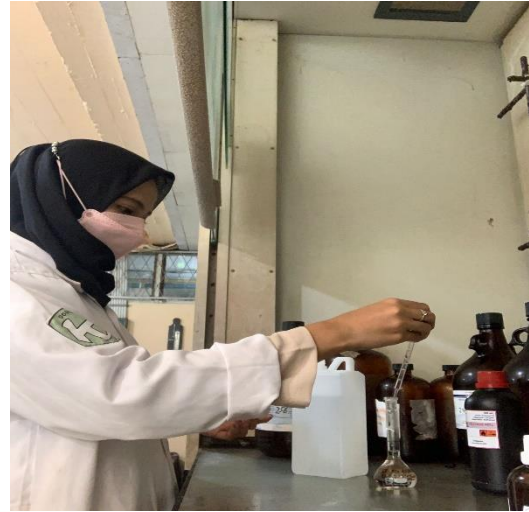
Gambar C.14 Pembuatan larutan NaOH dan HCl 2 M
