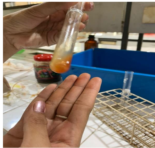
Gambar C.16 Pengujian kandungan antosianin dengan NaOH 2M
