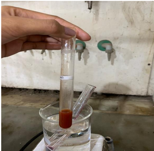
Gambar C.15 Pengujian kandungan antosianin dengan HCl 2M
