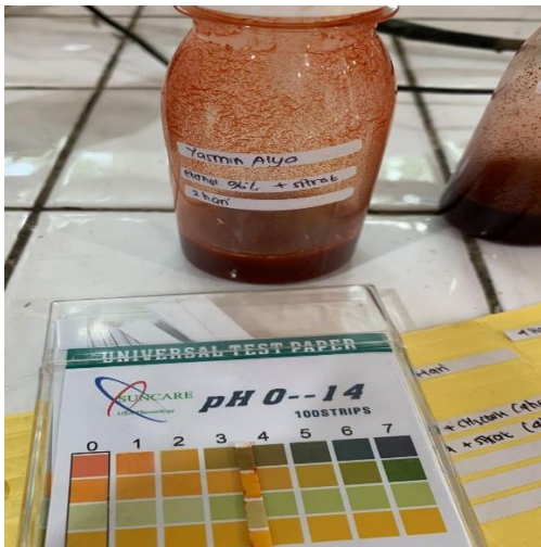
Gambar C.11 pH zat warna dengan penambahan asam sitrat 3% pada pelarut etanol
