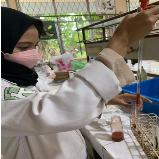
Gambar C.13 Pengambilan 2 ml ekstrak untuk pengujian kandungan antosianin
