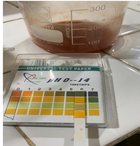
Gambar C.12 pH zat warna dengan penambahan asam asetat 3% pada pelarut etanol
