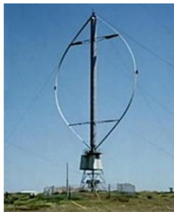
Gambar 2.2 Turbin Angin Darrieus (Zulfikar dkk., 2019)
