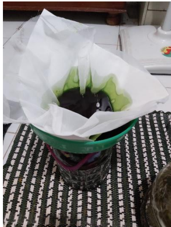
Gambar C.7 Penyaringan Hasil Maserasi Ekstrak Daun Waru
