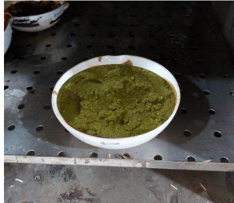
Gambar C.54 Campuran Ekstrak Dimasukkan ke dalam Oven hingga menjadi Serbuk Kering.
