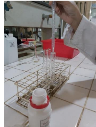
Gambar C.43 Memipet Larutan Buffer Fosfat ke dalam Tabung Reaksi.
