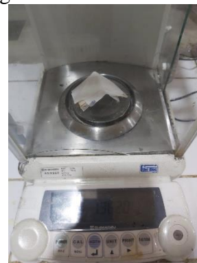
Gambar C.86 Penimbangan Kertas Saring Akhir
