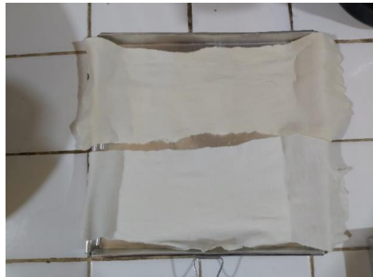
Gambar C.80 Hasil Dari Pencucian Tanpa Dibilas dan Pencucian dengan Dibilas.
