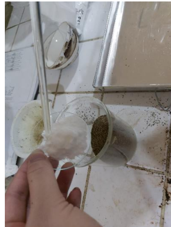
Gambar C.64 PVP Dimasukkan ke dalam Campuran.
