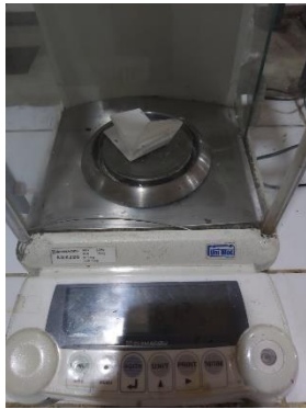
Gambar C.83 Penimbangan Kertas Saring Awal dengan Neraca Analitik.
