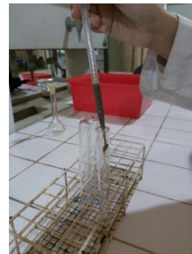
Gambar C.41 Memipet Ekstrak Enzim ke dalam Tabung Reaksi.
