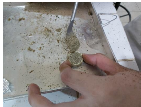
Gambar C.66 Proses Pencetakan Detergen Tablet Menggunakan Alat Cetak Sederhana.
