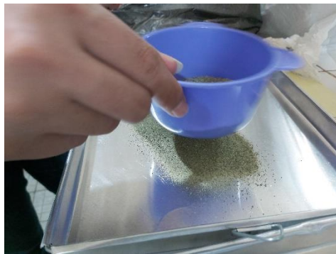
Gambar C.65 Penyaringan Serbuk Campuran Detergen.
