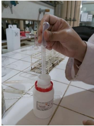
Gambar C. 42 Memipet 4 ml Larutan Buffer Fosfat.
