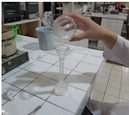
Gambar C.23 Natrium Asetat yang sudah Dilarutkan dengan Aquadest, Dimasukkan ke dalam Labu Ukur yang sudah Diisi Aquadest Terlebih Dahulu.
