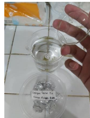
Gambar C.82 Pelarutan Sampel dengan Aquadest.
