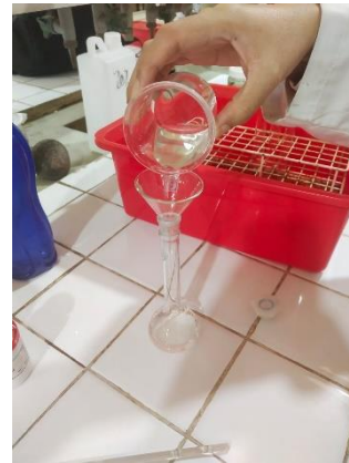
Gambar C.37 Melarutkan Kasein ke dalam 50 ml Aquadest
