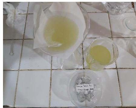
Gambar C.84 Penyaringan Larutan Sampel dengan Kertas Saring
