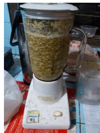
Gambar C.26 Kulit Nanas Dihomogenasi dengan 100 ml Larutan Buffer Asetat
