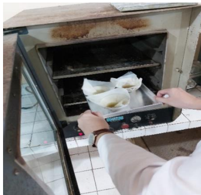
Gambar C.85 Dimasukkan ke dalam Oven Kertas Saring yang Berisi Bahan Tidak Larut.
