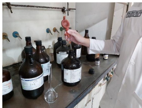
Gambar C.19 Mengambil Asam Asetat Glacial sebanyak 2,9 ml dengan Pipet Ukur.
