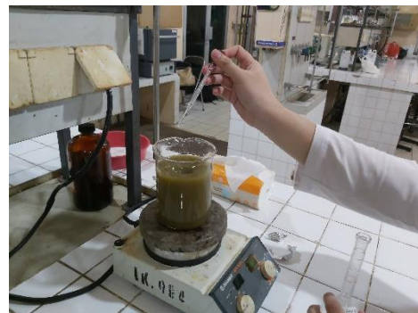
Gambar C.32 Selama Pengadukan Ditambahkan Larutan Amonium Sulfat 60% Sedikit Demi Sedikit.
