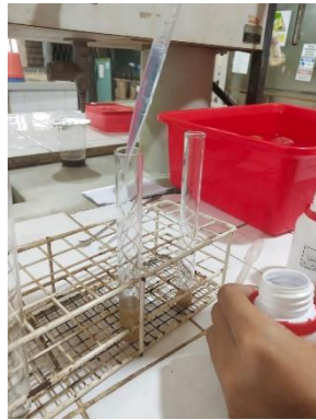
Gambar C.46 Memipet 2 ml Reagen Biuret ke dalam Campuran.
