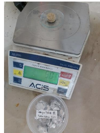
Gambar C.73 Penimbangan Sampel untuk Uji Daya Detergen
