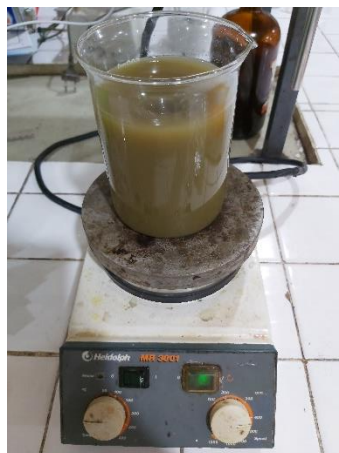
Gambar C.31 Larutan Ekstrak Diaduk Menggunakan Pengaduk Magnet selama 45 Menit.
