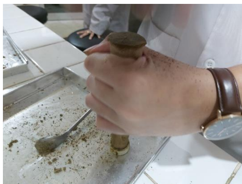
Gambar C.67 Proses Pencetakan Detergen Tablet Menggunakan Alat Cetak Sederhana.
