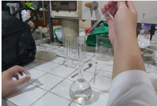
Gambar C.21 Menambahkan Aquadest pada Larutan Asam Asetat Glacial sampai Tanda Batas
