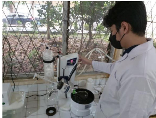
Gambar C.9 Evaporasi dengan Rotary Evaporator
