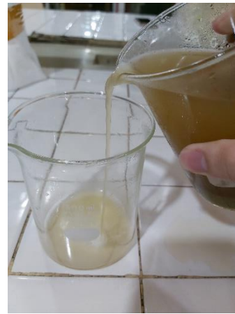
Gambar C.34 Larutan Didekantasi hingga Didapatkan Endapan.
