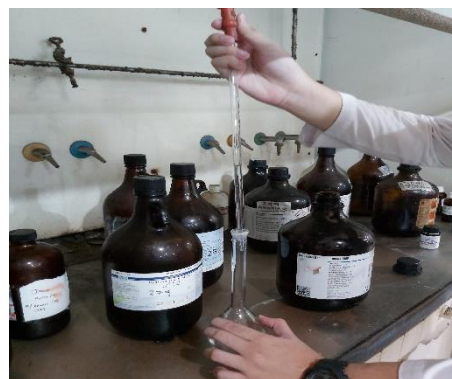
Gambar C.20 Asam Asetat Glacial ke alam Labu Ukur 250 ml.
