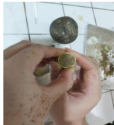
Gambar C.68 Proses Pencetakan Detergen Tablet Menggunakan Alat Cetak Sederhana.
