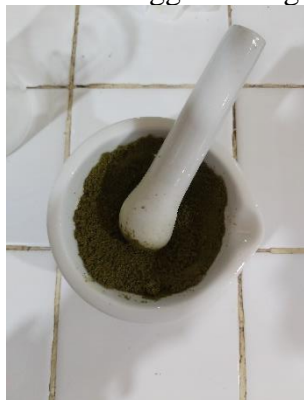
Gambar C.55 Campuran yang sudah menjadi Serbuk Kering, Dihaluskan dengan Mortar
