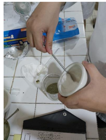
Gambar C.62 SLS Dimasukkan ke dalam Campuran.
