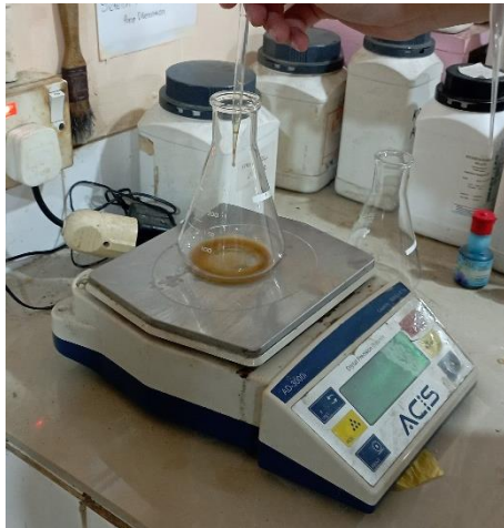
C17. Menimbang 2 gr sampel minyak biji pepaya
