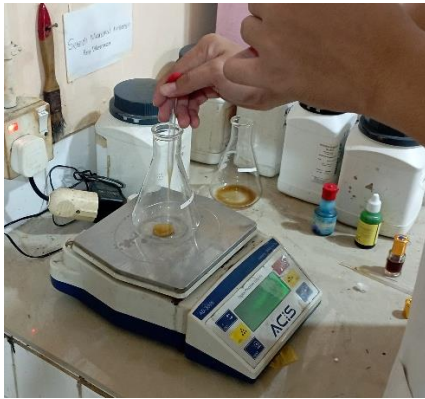
C11. Menimbang 2 gr sampel minyak biji pepaya dan dimasukkan ke dalam erlenmeyer 250 ml
