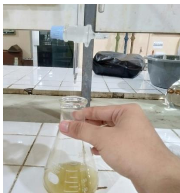
C15. Menitrasi dengan larutan HCL 0,5N
