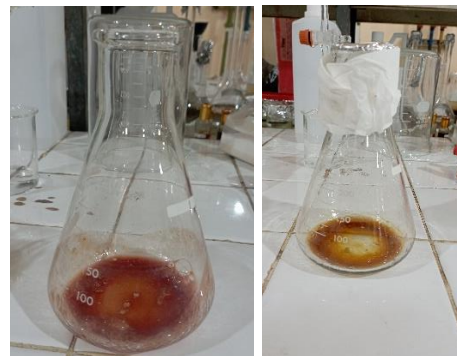
C16. Larutan dititrasi sampai warna indikator berubah menjadi tidak berwarna
