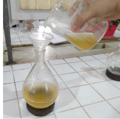
C8. Menuangkan hasil ekstraksi ke dalam labu rotary evaporator
