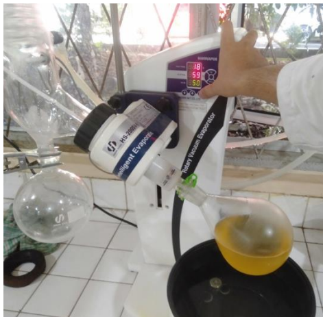
C9. Menjalankan proses evaporasi alat rotary evaporator dengan mengatur suhu 90°C dan 50 RPM
