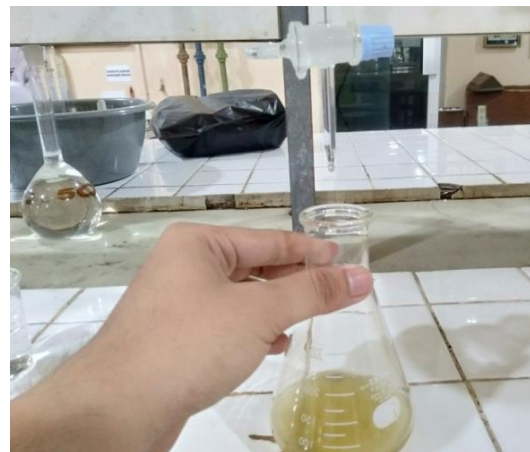
C20. Menitrasi dengan larutan standar KOH 0,1N hingga berwarna merah muda
