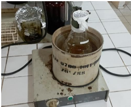
C13. Mendidihkan sampel pada waterbath selama 1 jam
