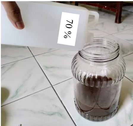
C3. Menambahkan 1000 ml etanol 70% sebagai pelarut
