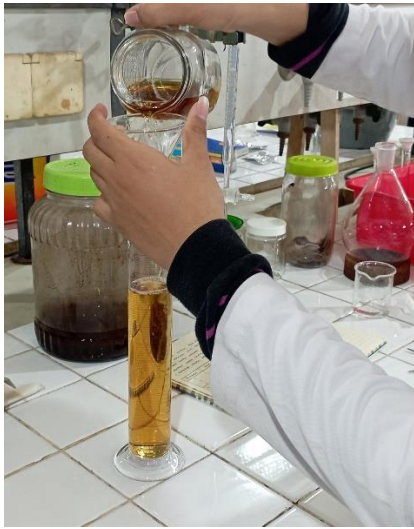
C7. Mengukur volume hasil maserasi untuk tahap rotary evaporator
