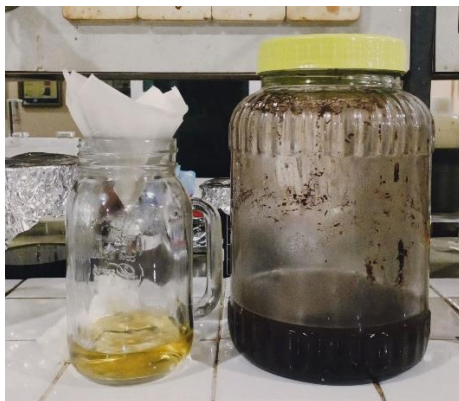
C5. Memisahkan hasil maserasi dari biji pepaya dengan menggunakan kertas saring
