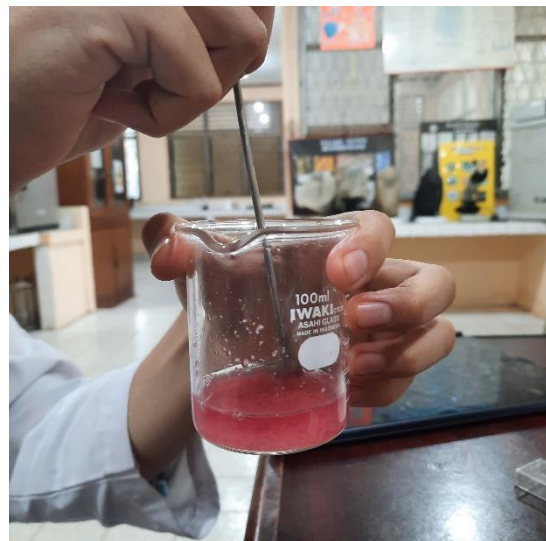
Gambar C.32 Proses pencampuran serbuk antosianin kulit buah naga merah dengan air untuk pengukuran pH.
