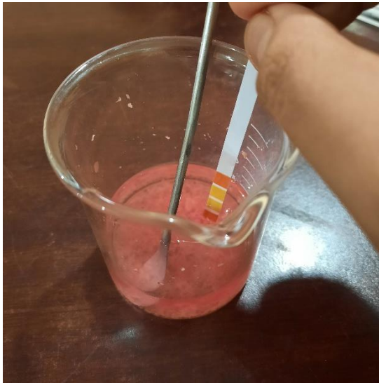
Gambar C.33 Proses analisa pengukuran pH serbuk antosianin kulit buah naga merah.
