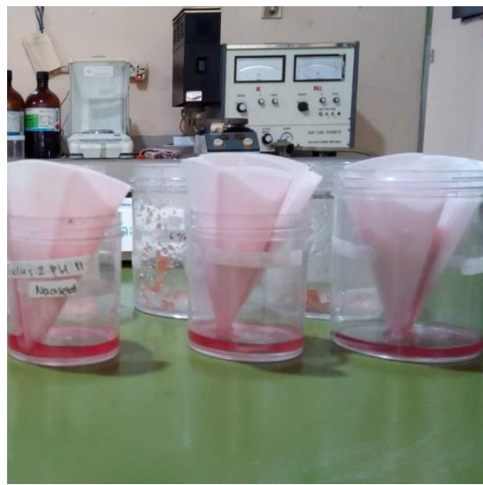
Gambar C.35 Proses analisa intensitas warna (absorbansi) spektrofotometer uv-vis Serbuk antosianin kulit buah naga merah.
