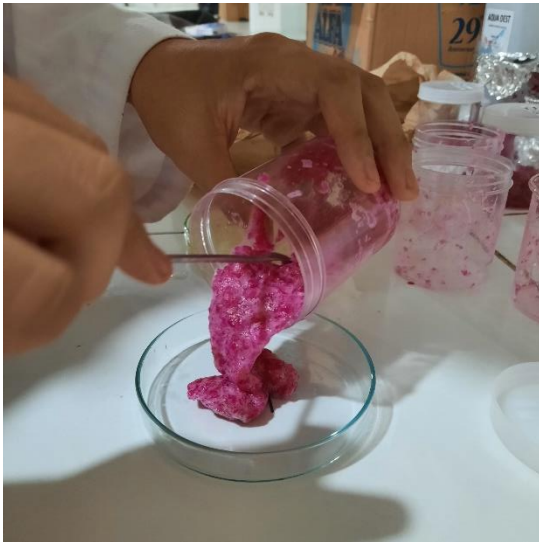
Gambar C.23 Proses pemindahan campuran ekstraksi kulit buah naga merah ke cawan petri.
