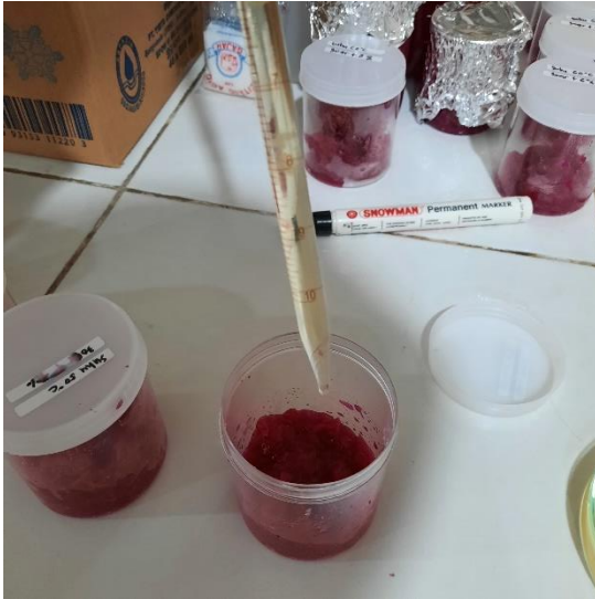
Gambar C.21 Proses penambahan putih telur pada ekstraksi kulit buah naga merah.
