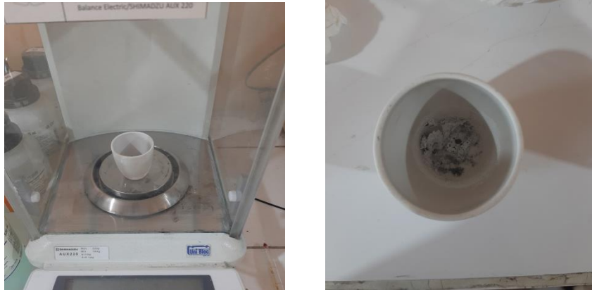
Gambar 26. Menimbang Hasil Kadar Abu yang Didapat
