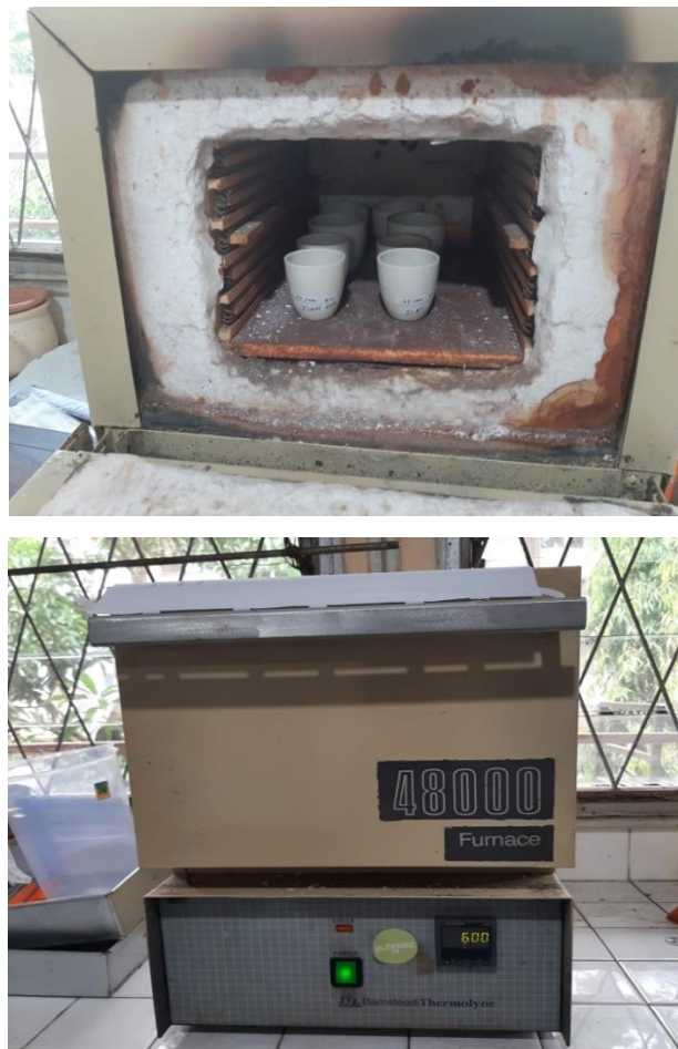
Gambar 25. Kemudian Dimasukan Kedalam Furnace Dengan Suhu 600°C Selama 4 Jam
