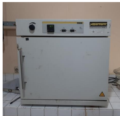
Gambar 21. Proses Pengovenan (Uji Kadar Air) pada suhu 105°C Selama 1 Jam
