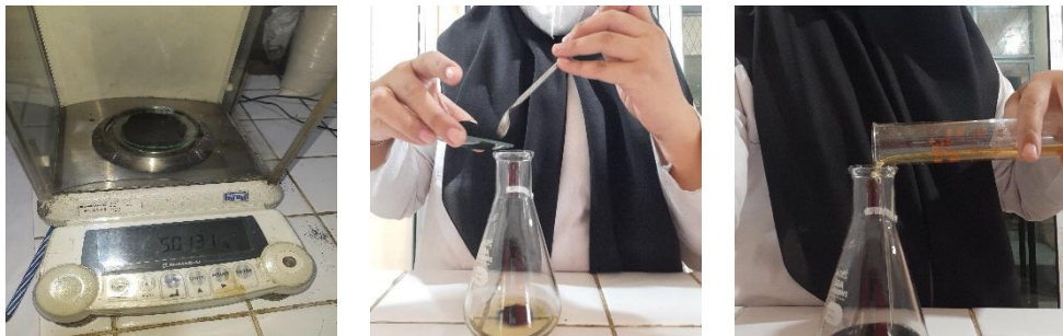
Gambar C.11 Proses perendaman adsorben sebanyak 5gr kedalam 100ml minyak jelantah
