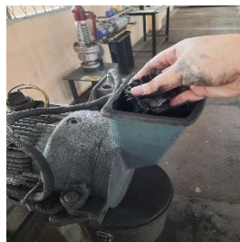
Gambar C.5 Proses penghalusan adsorben menggunakan grinding
