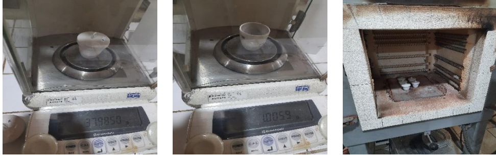
Gambar C.10 Proses analisa kadar abu adsorben dengan cara memfurnace 1gr adsorben dengan suhu 650^{\circ}\text{C} selama 4 jam
