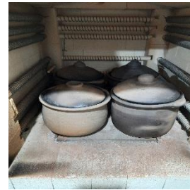
Gambar C. 3 Kendi yang berisi bahan baku di furnace pada suhu 400 0 C selama 4 jam.
