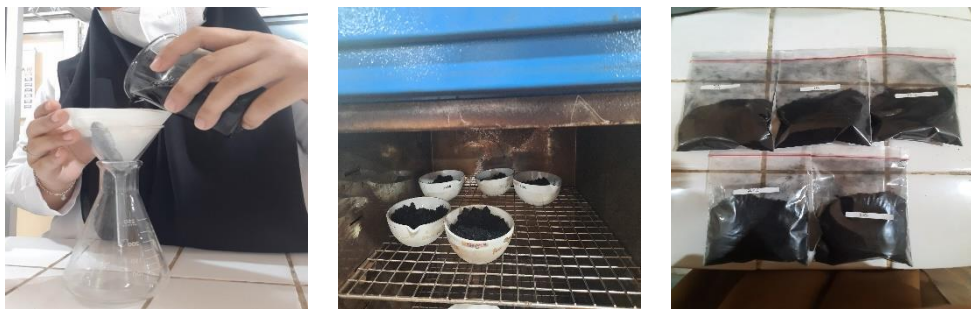
Gambar C.8 Proses menetralkan pH adsorben dan pengeringan adsorben yang telah memiliki pH yang netral
