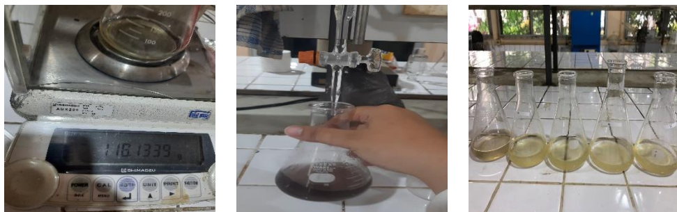
Gambar C.15 Proses analisa bilangan peroksida minyak jelantah dengan cara menitrasi 5gr minyak jelantah yang telah di tambahkan 30ml larutan asamasetat glasial-kloroform(3:2), 0,5ml larutan KI jenuh, dan 0,5ml larutan kanji menggunakan larutan \text{Na}_2\text{S}_2\text{O}_3 0,012N
