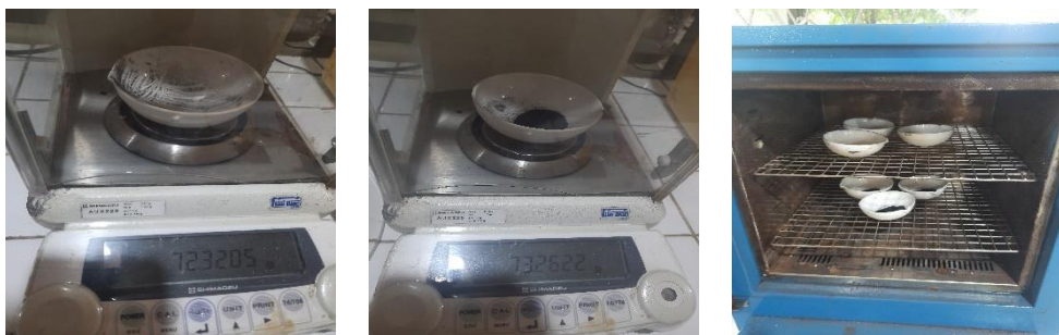
Gambar C.9 Proses analisa kadar air adsorben dengan cara mengoven 1gr adsorben dengan suhu 105^{\circ}C hingga mendapatkan berat yang konstan.
