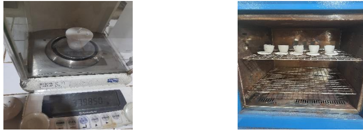
Gambar C.13 Proses analisa kadar air minyak jelantah dengan cara mengoven 5 gr adsorben dengan suhu 130^{\circ}\text{C} hingga mendapatkan berat yang konstan.
