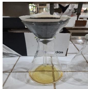
Gambar C.12 Setelah direndam selama 24 jam dilakukan penyaringan adsorben dan minyak jelantah.
