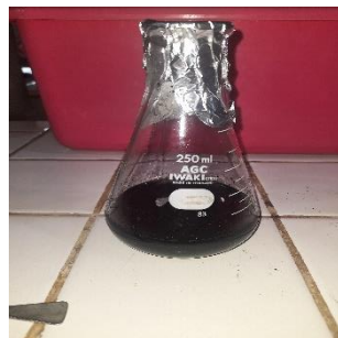
Gambar C.12 Setelah direndam selama 24 jam dilakukan penyaringan adsorben dan minyak jelantah.
