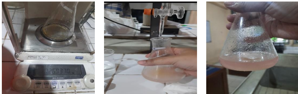
Gambar C.14 Proses analisa bilangan asam minyak jelantah dengan cara menitrasi 10gr minyak jelantah yang telah di tambahkan 50ml etanol hangat dan 5 tetes larutan fenolftalein menggunakan larutan KOH 0,1 N
